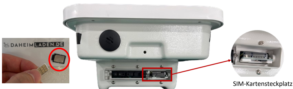
Abbildung 12 – Steckplatz für 4G-SIM-Karten
